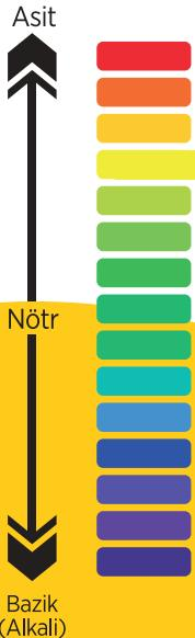
BALANCE INDICATOR renk skalarına göre ilaçlama suyunuzu ayarlamaya yardımcı pH düzenleyicidir. İlaçlama tankında renk **açık sarı** olduğu zaman pH değeri **5,5-6,5** değerini almış olacaktır.
